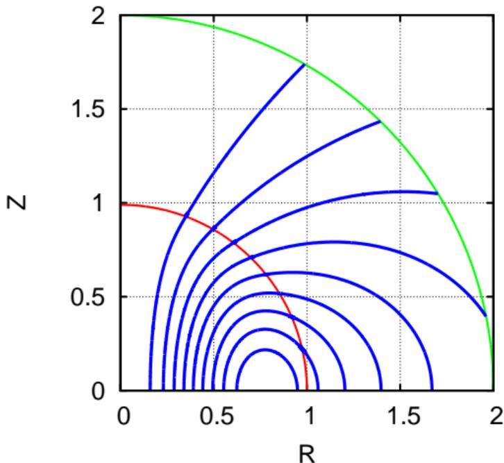
Figure: 磁力線. Poloidal 磁場を表す. この磁力線に沿って値が等しいスカラー関数が flux function  $\Psi$  である.
