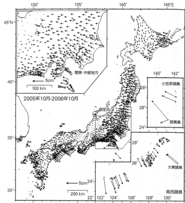
図1-6 GPS観測網により明らかになった日本全国の地殻変動(新潟県大潟観測点(図中に黒点と示す)に対する2005年10月から2006年10月までの各観測点での変動を矢印で示す)
