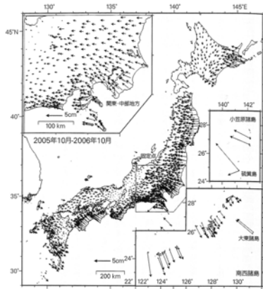
図1-6 GPS観測により明らかになった日本全国の地殻変動。新潟県大潟観測点(図中に固定点と示す)に対する2005年10月から2006年10月までの各種観測点での変動を矢印で示す。
